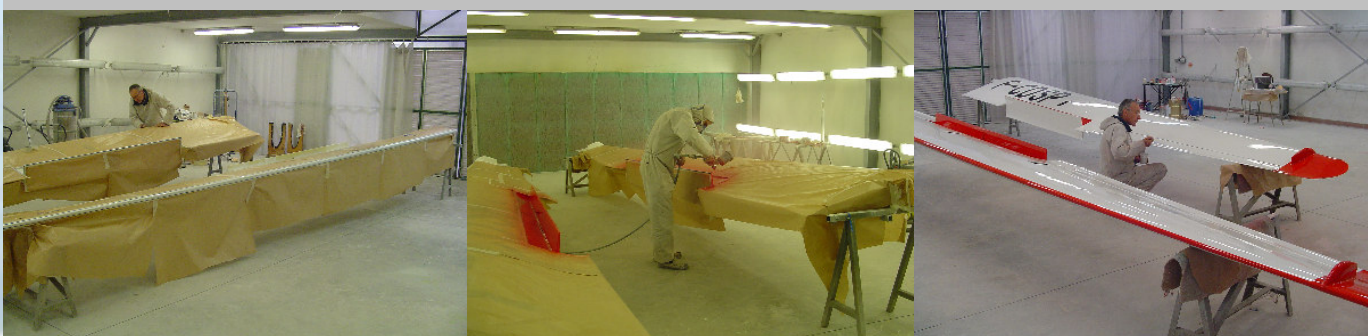
10) Après 48 heures de séchage, nous arrivons à la décoration et à l'immatriculation de l'aile gauche. Simple, mais rendant bien visible le planeur. (Photos : Francis)
