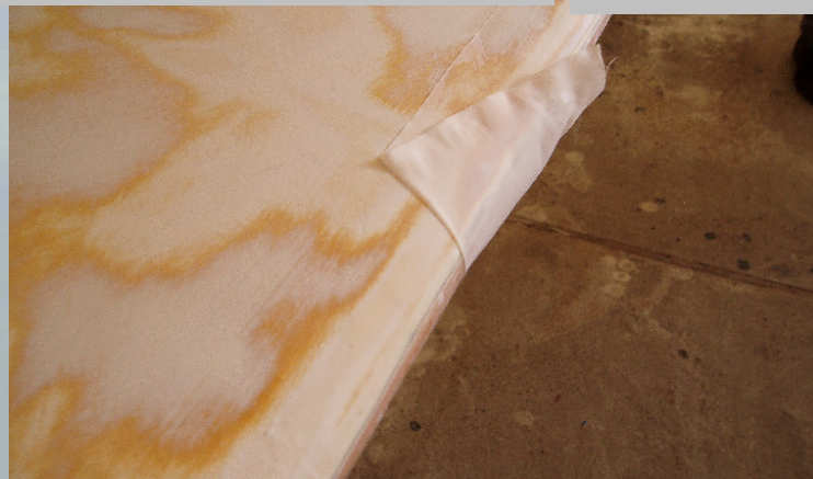
4) Marouflage des bords d'attaque avec fibre de verre légère + résine époxy et tissu « d'arrachage » (que l'on voit ici lors de son enlèvement) : résultat nickel !
