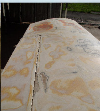
2) Zones non adhérentes sur les bordures : à rattrapper au microballon + époxy
