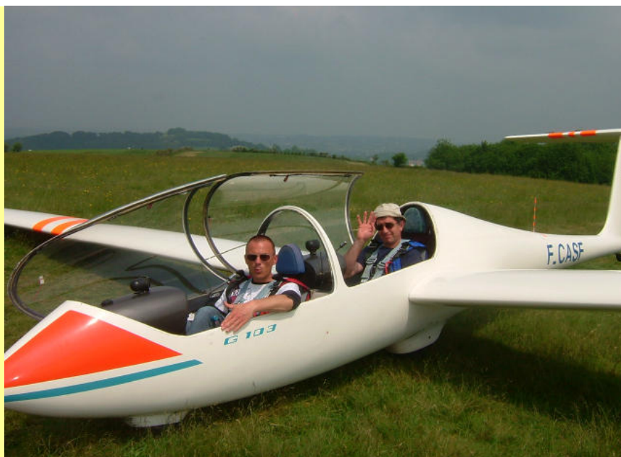
Le Twin II biplace utilisé pour l'écolage (ici, lors d'un stage chez nos amis d'Ixassou). Planeur de la firme allemande Grob, type G103.
